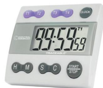
609-0226 Таймер-секундомер 4 канала, с часами
