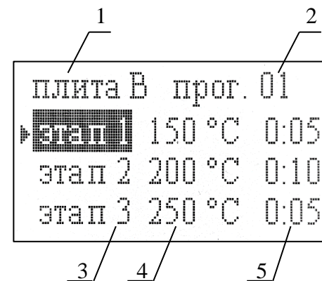
1 – название секции, для которой высвечена программа; 2 – номер программы; 3 – номер этапа программы; 4 – температура в градусах Цельсия, поддерживаемая при выполнении этапа; 5 – время выполнения этапа в минутах.
