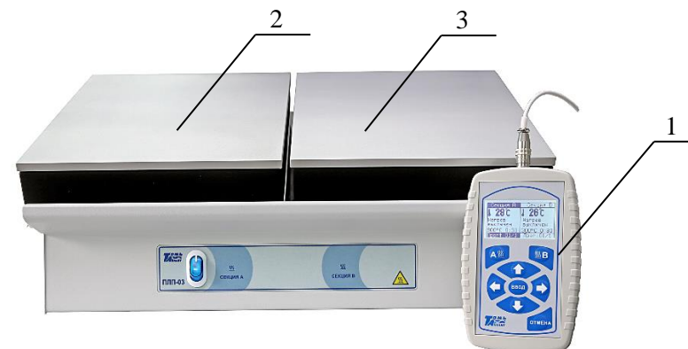
1 – пульт управления; 2 – секция нагрева А; 3 – секция нагрева В.
