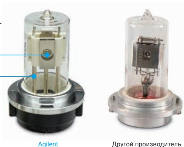
Надежность конструкции дейтериевой лампы от Agilent очевидна. Более узкая апертура позволяет уменьшить уровень шума и обеспечить более низкие пределы детектирования, что расширяет возможности обнаружения и улучшает результаты количественного определения следовых количеств анализируемых веществ.
